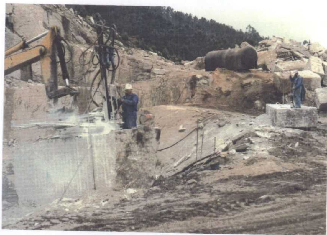
0.25.- Bateria de martillos perforando sin inyección, barrenista protegido con mascarilla
