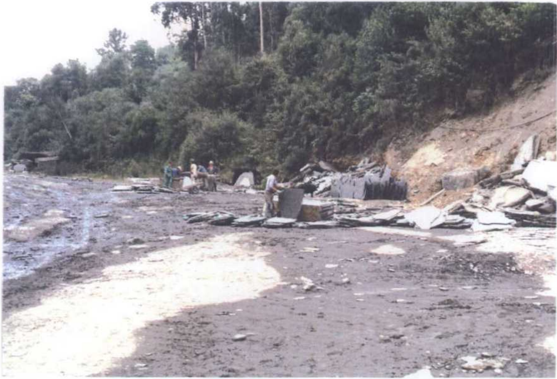
C-9.- Labradores elaborando rumbeiros a pié de cantera
