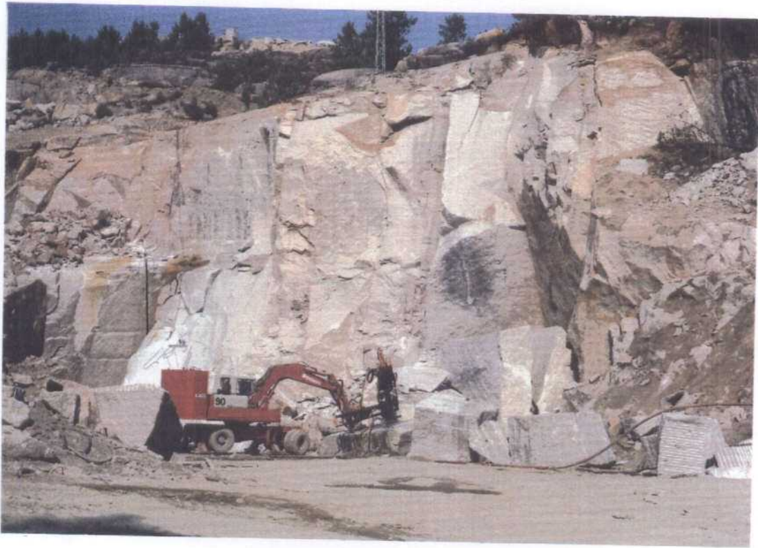
P-36.- Equipo de perforación trabajando con inyección de agua
