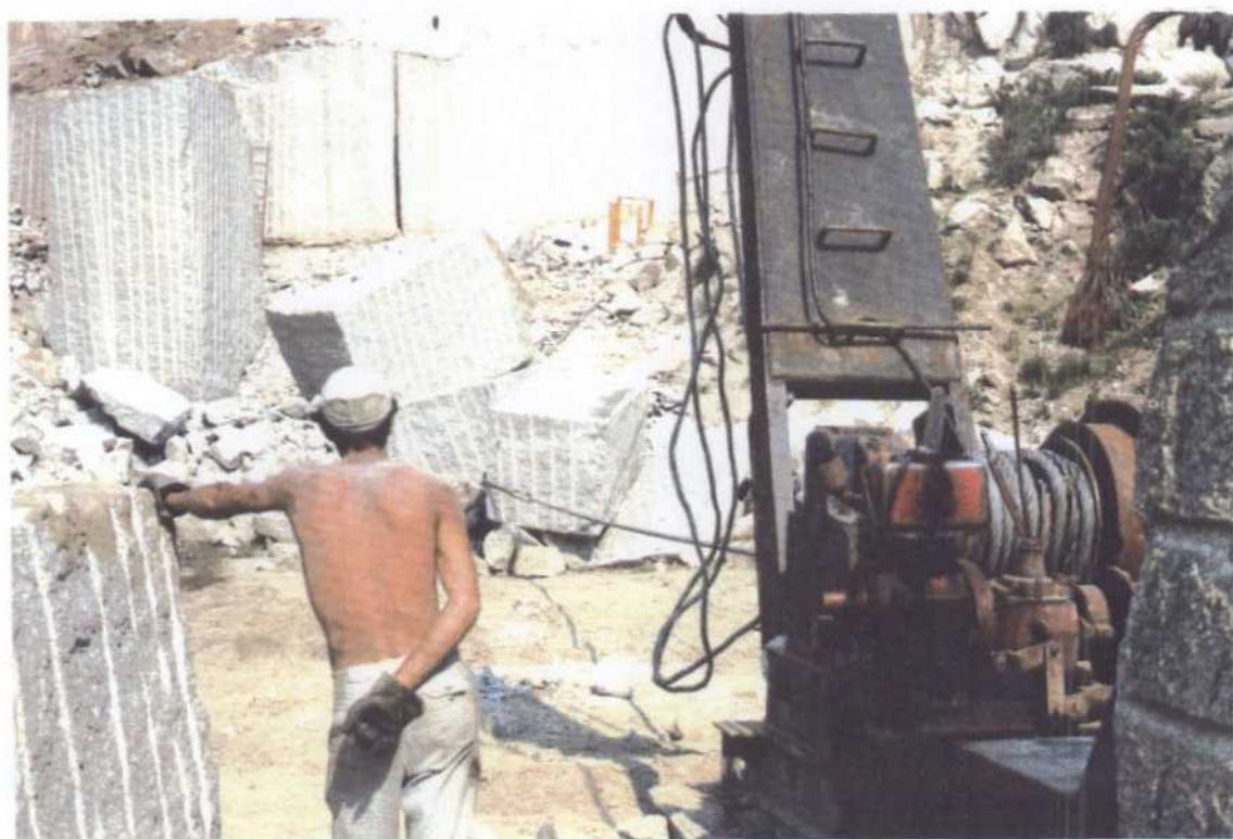
L.28.- Cabrestante tirando de un bloque y un operario en su entorno
